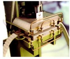
Le cinghie aperte Megadyne sono realizzate in poliuretano con un'alta resistenza all'usura e all'abrasione e con trefoli in acciaio ad elevata resistenza.
