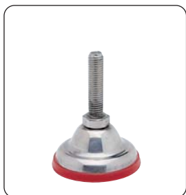
Part. R0384 - Pag. R56 Ø 65 • Stainless steel • Hygiene • Max. load 12000 N.
