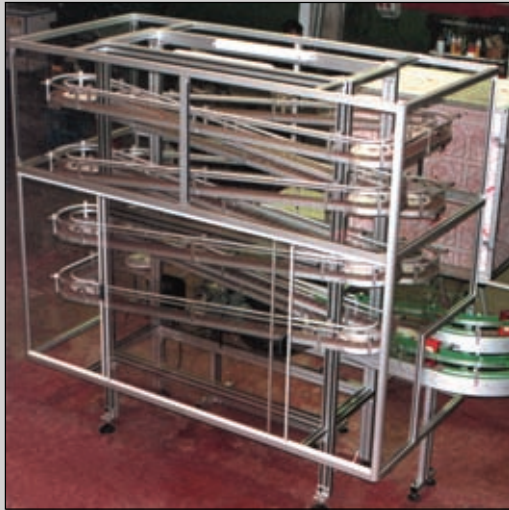
Transportador de acumulación + Carenado / Accumulation conveyor + Frame / Convoyeur d'accumulation + Carenage
