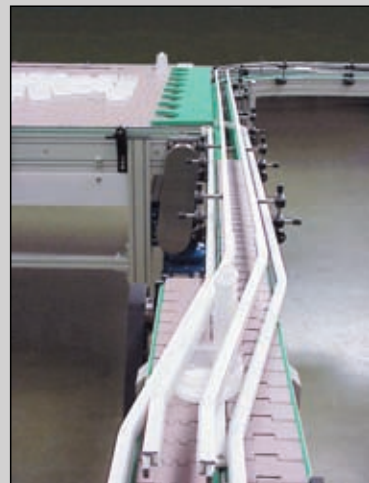
Mesa de acumulación sin presión / Accumulation table without pressure / Table d'accumulation sans pression
